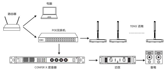
该图为系统连接示意图，Dante 技术允许在一条以太网线上同时发送和接收许多的音频通道，更多连接使用方案请联系我们工程师。
