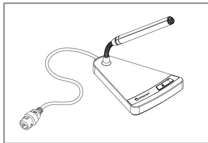
TDN3 是一款 Dante 网络桌面式会议话筒，管体采用细小的三角造型的鹅颈设计结构，匹配高品质的电容式拾音器，可轻易将拾音头灵活调节到任何位置，并有效地拾取话筒前声音并利话筒结构压抑旁边及末端的灵敏度来提高演讲者的声音减少环境噪音的干扰。
